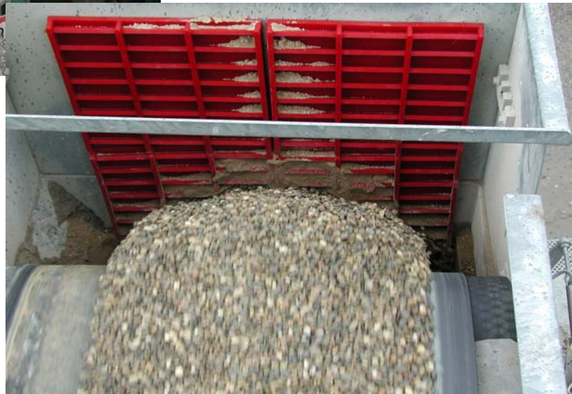
Stortschotten bij een grinderij. Meer dan 2 miljoen ton grind en nog steeds in gebruik.
